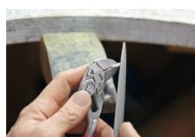
Traditionell skruvnyckel: kantpressning leder till skador
