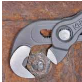
Självlåsande: ingen glidning på arbetsstycket och mindre kraftansträngning
