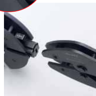
Väl synlig markering av crimpinsatser med piktogram
