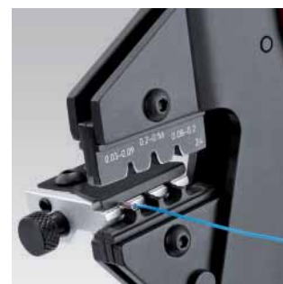
97 43 200 med crimpinsats 97 49 24 och positioneringshjälp 97 49 93 för D-Sub kontakt
