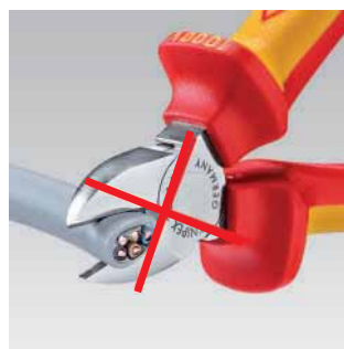
Kabelskärning med sidavbitare: hög kraftansträngning, oexakt snitt, stark deformation och klämning av kabeln
