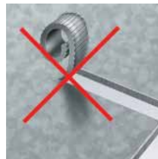
Utklippning utan spånbreakare
