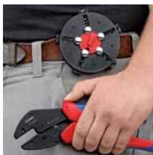
Magasinet för crimpinsatser kan bäras i bältet
