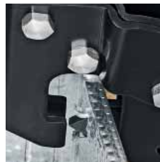
Stansverket pressas genom profilplåtarna
