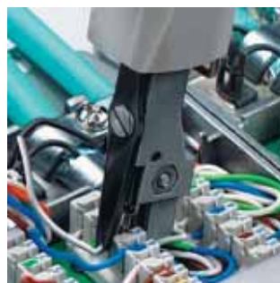
Kabeln kan tryckas in och skäras av i ett arbetsmoment
