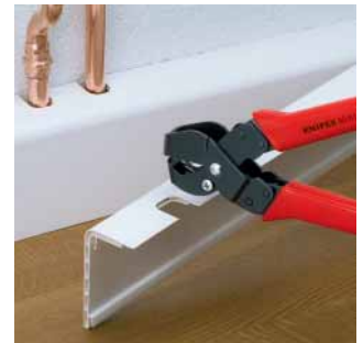
Specialtång för speciella användningar, t ex för utklippning eller urstansning av olika material (nibblingsverktyg, kabelhåltång osv)
