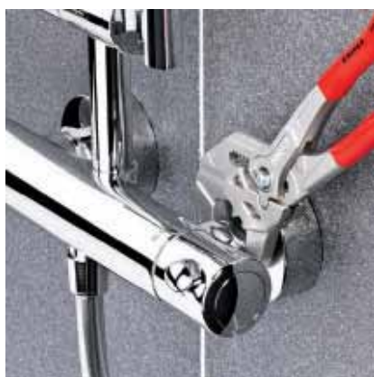
Arbeten på förkromad armatur utan att skada ytan
