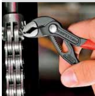
Mot rotationsriktningen förskjutna tänder åstadkommer en självklämmande effekt och förhindrar glidning på arbetsstycket.
