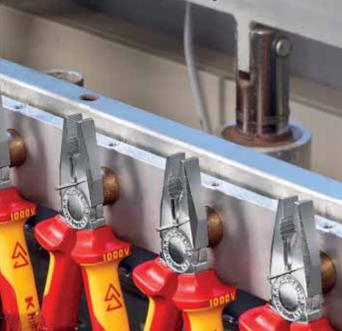
Spänningsprovning av varje tång med 10 000 V AC.
