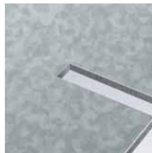
Utklippning och spånbreakning i ett arbetsmoment
