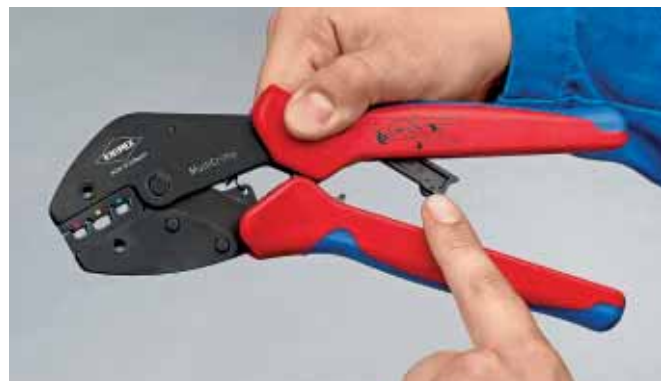
Fäll in servicespaken och tryck igenom tången – klar för nästa användning
