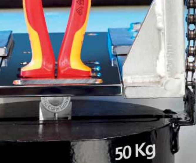
Provning av isoleringsöverdragets vidhäftningsförmåga med 500 N.
