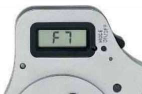
Multifunktionell digitaldisplay, inställning i mm, tum eller jämförbar selektorposition enligt MIL
