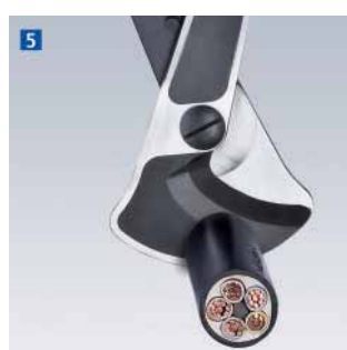
Upprepa skär- och öppningsproceduren tills kabel är kapad
