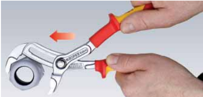
Snabbinställning på arbetsstycket utan tryckknappsmanövrering
