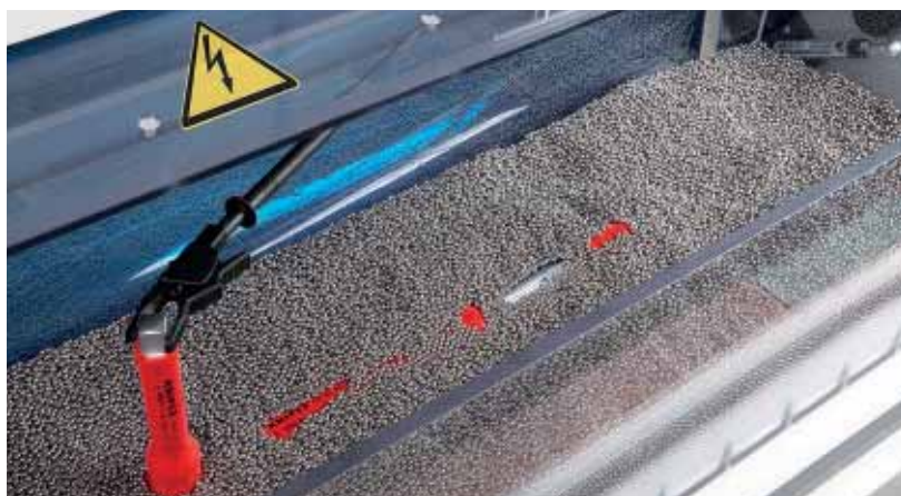
Provning av de elektriska isolationsegenskaperna.
