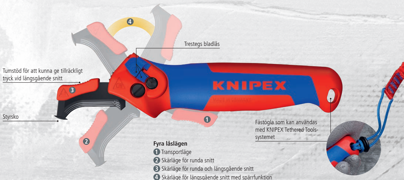
Spärrfunktionen möjliggör smidigare skalning till en mindre ansträngning
