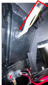
Åtkomsthål och gummigenomföring (C)
