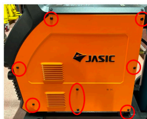
8 fästskravar för sidopanelen (B)
