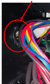
Åtkomsthål och gummigenomföring (C) jordledning (D)
